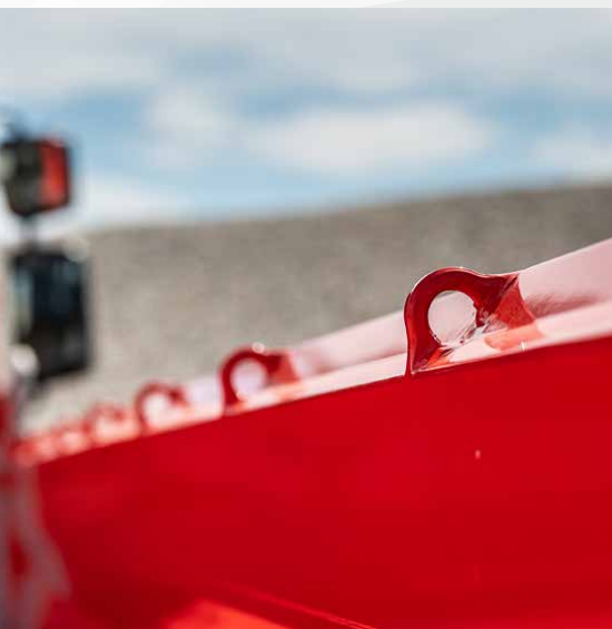
Bord- und Stirnwandwandzurrösen auch bei Transportern und leichten 2-Achsern
