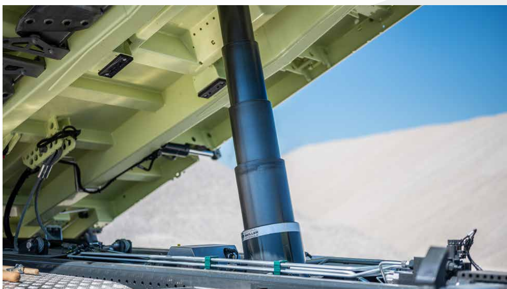
NEU: Nur ein Hydraulik-Teleskopzylinder beim 4-Achser
